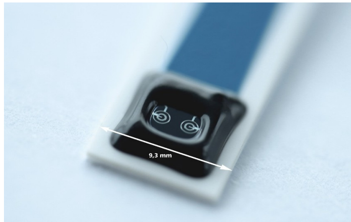
Elektrochemischer Analytikchip verkapselt auf Keramikplatine, für die elektrochemische Messung von Flüssigkeiten..
