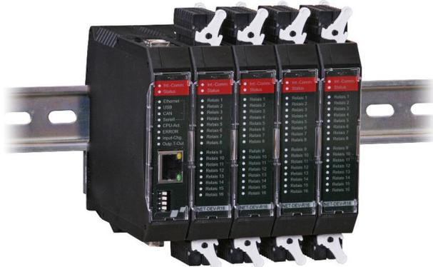
Durch den flexiblen und modularen Aufbau lassen sich bis zu 64 verschiedene I/O-Einheiten, sogenannte NET-DEV I/Os, kombinieren. Somit können beispielsweise Konfigurationen mit **1024 Relais Ausgängen** realisiert werden.
