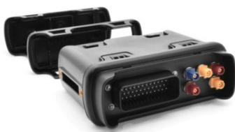
Owa4x mit Schutzklappen für IP67 Standard
