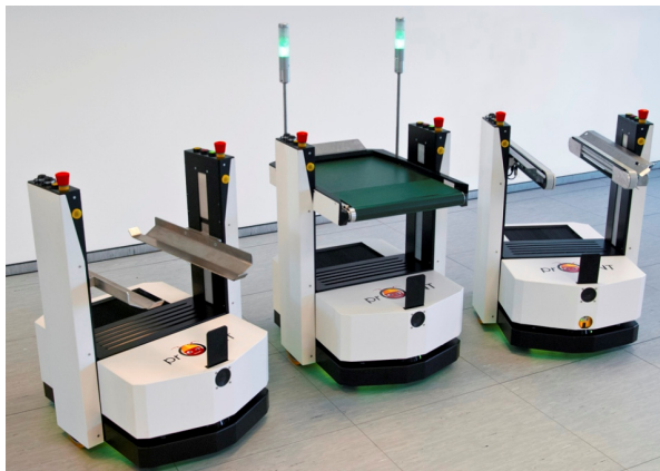
proANT AGV mit drei verschiedenen Lastaufnahmen und mit Hub
